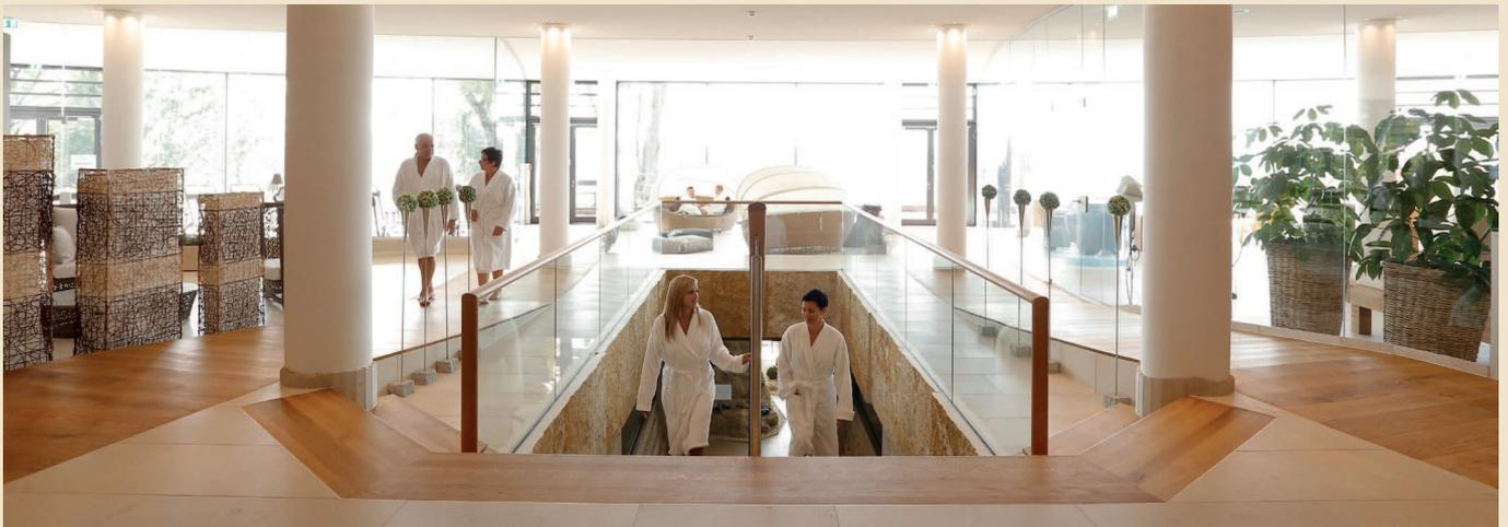
Das Steinboden-Design wurde durch die Natursteinmanufaktur Strauß GmbH gemeinsam mit dem Bauherren des Mawell Resorts und dem Architekten entwickelt und realisiert. Der Steinbelag wurde vor Ort an die konkav und konvex geformten Holzböden angepasst. So entstand ein harmonischer Gesamteindruck. Der ausgesuchte Natursteinbelag hat durch seine satinierte Oberfläche eine angenehme Oberflächenhaptik und strahlt Wärme und Ruhe aus.
